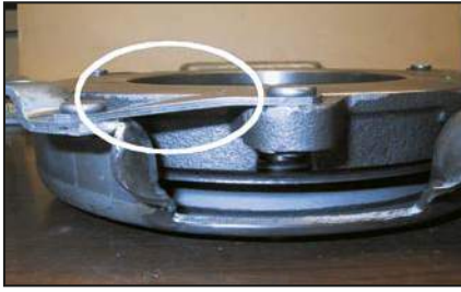
Elemento deformato Deformed drive straps Elemento elástico deformado Patilha deformada Деформированные ведущие накладки
